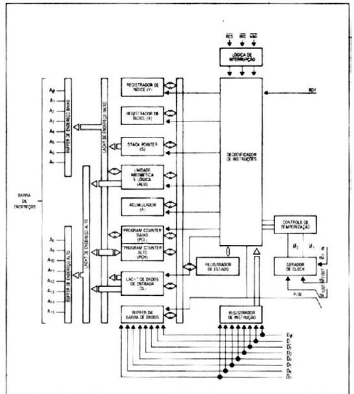
Figura 1 — Diagrama de blocos do microprocessador 6502
